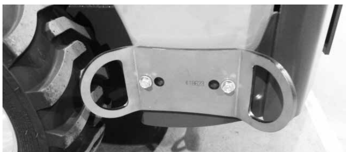
Surrningsögla A418623 monterad bakom bakdäcken. För montering på sidan behövs två surrningsöglor.
