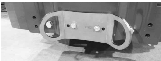
Surrningsögla A418623 monterad på den bakre stötfångaren eller bakvikten
